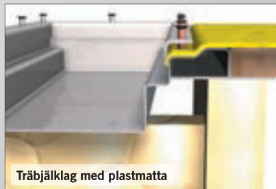
Klinker i fästmassa på plastmatta
