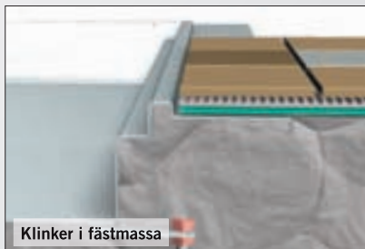
Betongolv med klinker utan tätskikt
