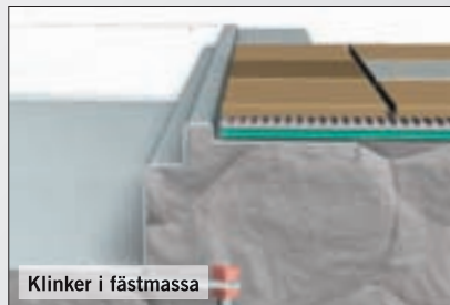
Betongolv med klinker utan tätskikt
