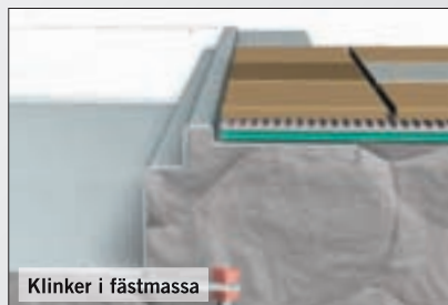
Betongolv med klinker utan tätsikt
