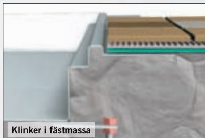
Betonggolv med klinker utan tätskikt
