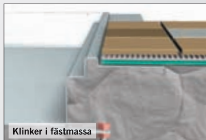
Betongolv med klinker utan tätsikt
