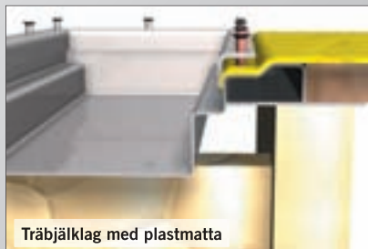
Klinker i fästmassa på plastmatta
