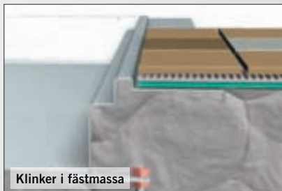
Betonggolv med klinker utan tätskikt
