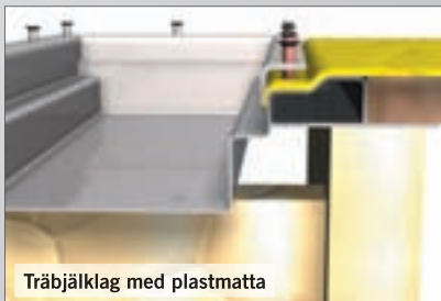
Klinker i fästmassa på plastmatta
