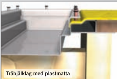
Klinker i fästmassa på plastmatta
